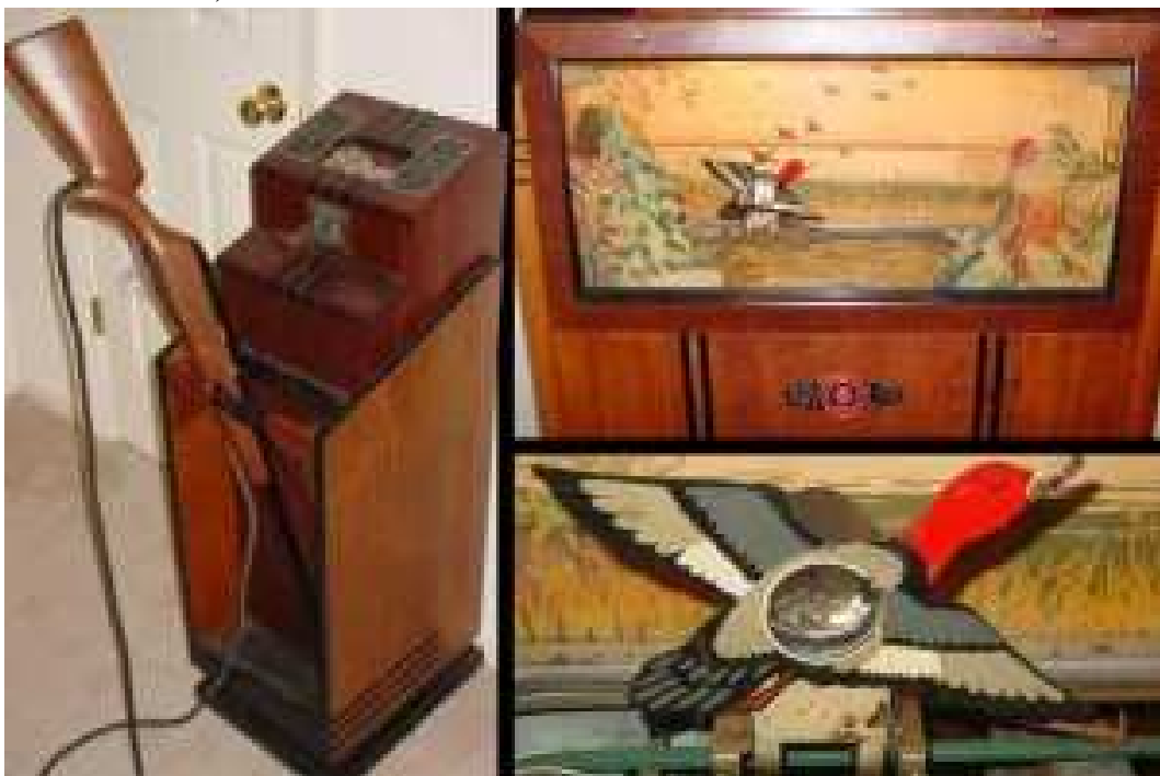
Figura 3 – Fotos do Ray-o-light, mostrando a máquina e o simulacro de rifle (imagem à esquerda), o display (imagem superior direita) e o alvo utilizado no arcade (imagem inferior direita)
