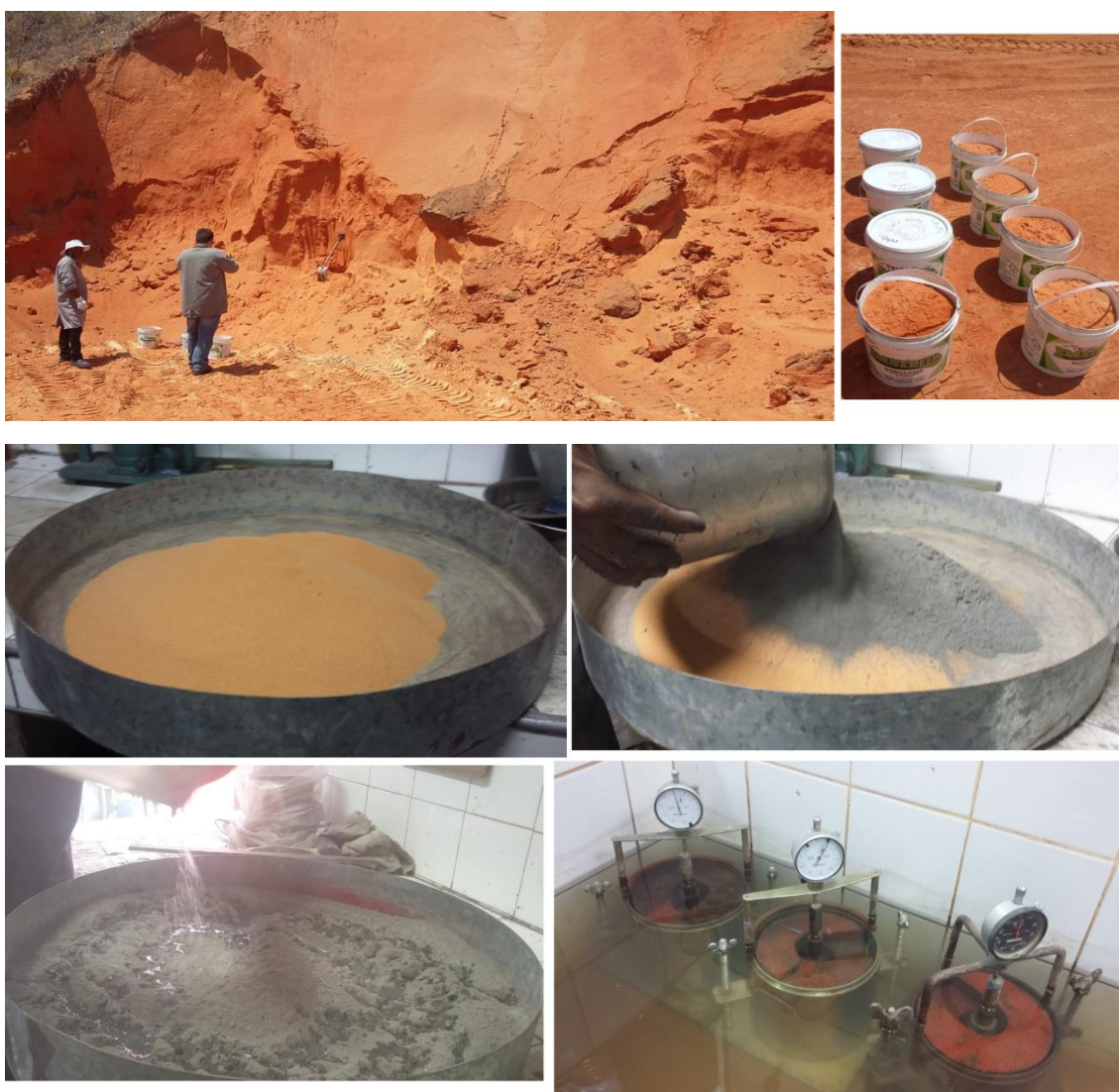
Figura 1.5: Estabilização Granulométrica das Cinzas
