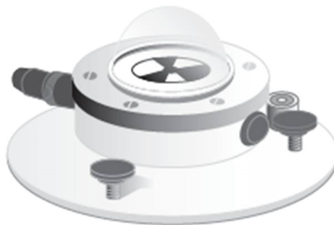
Figura 31 – Piranômetro com pilha termoelétrica
