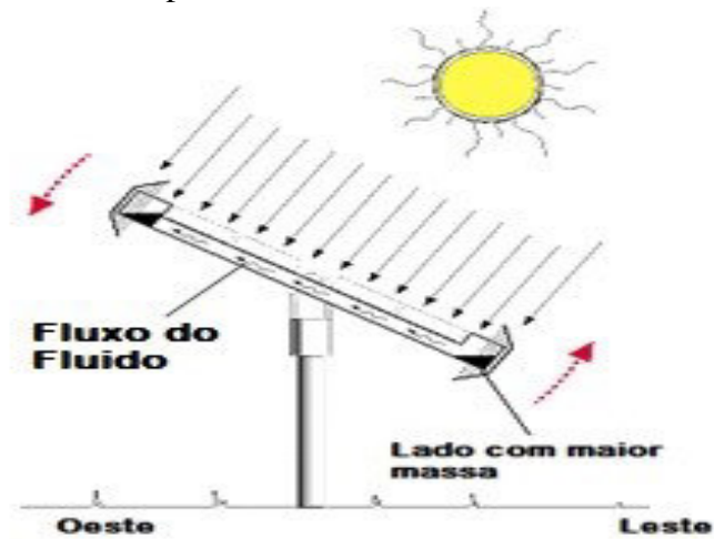
Figura 25 – Sistema controlador passivo
