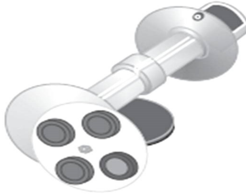
Figura 33 – Pireliômetro para medição de radiação solar direta
