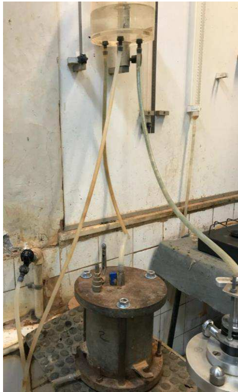
Figura 5- Amostra de solo em fase de saturação em cilindro de parede rígida.
