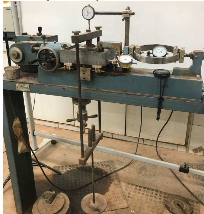
Figura 6 - Equipamento utilizado para a execução dos ensaios de cisalhamento direto.
