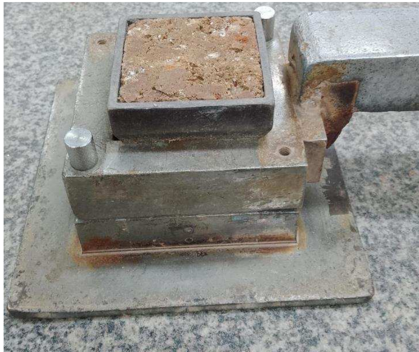
Figura 7 - Amostra de solo com fibras no molde cisalhamento direto.
