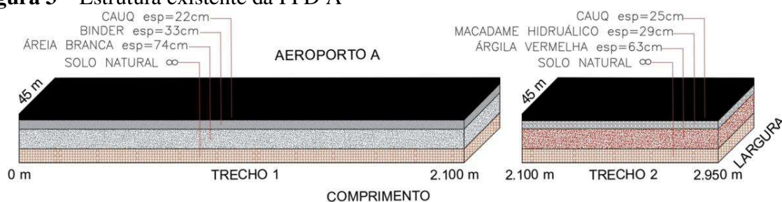
Figura 3 – Estrutura existente da PPD A
