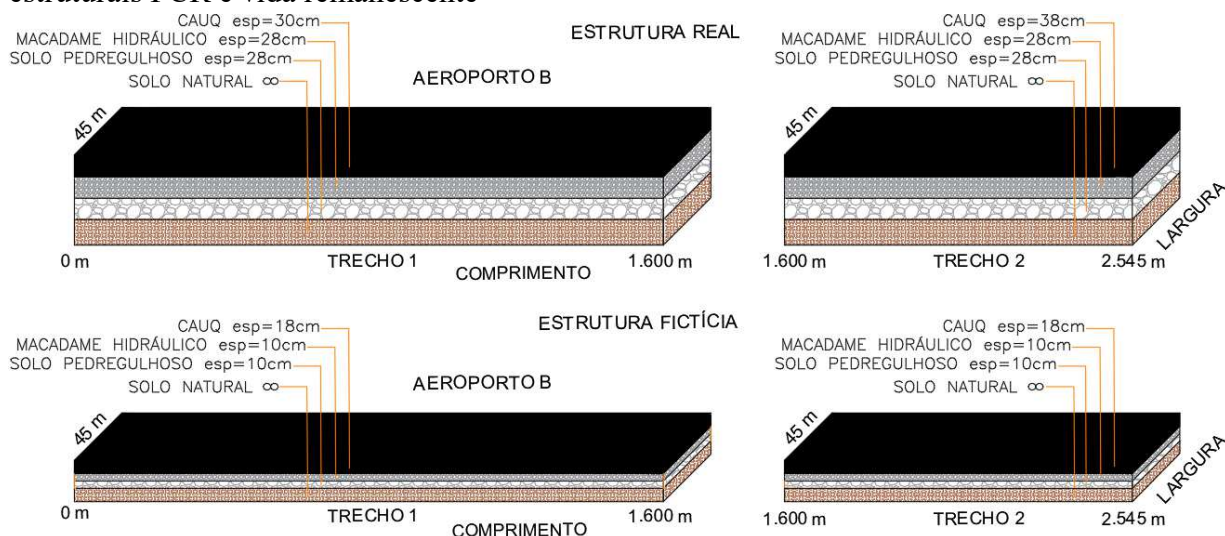
Figura 48 – Estrutura fictícia do estudo de caso da PPD B para o cálculo dos parâmetros estruturais PCR e vida remanescente
