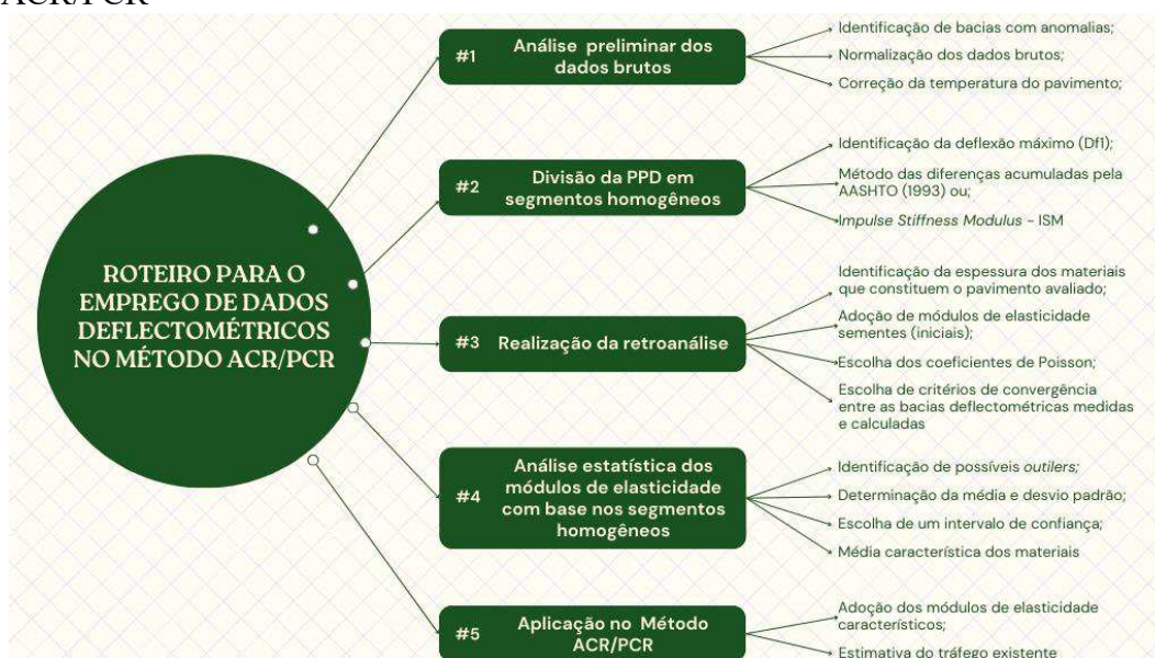
Figura 1 - Proposta de protocolo para o emprego de dados deflectométricos no Método ACR/PCR
