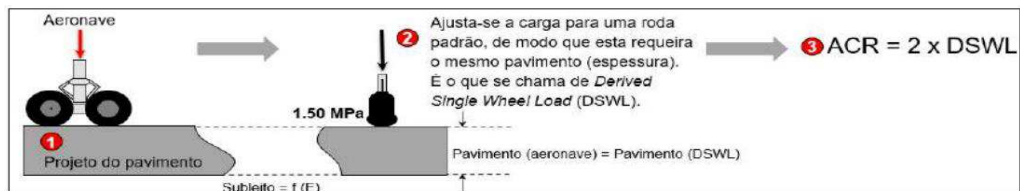
Figura 3 - Procedimento utilizado para determinação do ACR de aeronaves em pavimentos flexíveis
