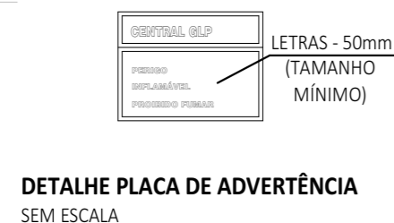
DETALHE PLACA DE ADVERTÊNCIA SEM ESCALA
