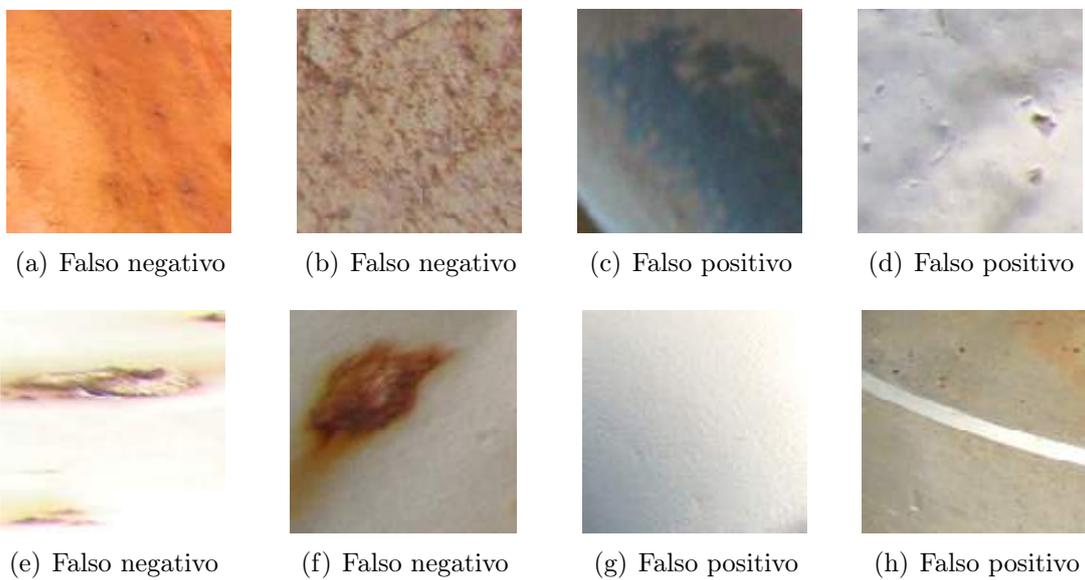
**Figura 6.9:** Exemplo de imagens de corrosão classificadas incorretamente usando o conjunto de descritores da (a-d) MIDE e (e-g) GLCM.
