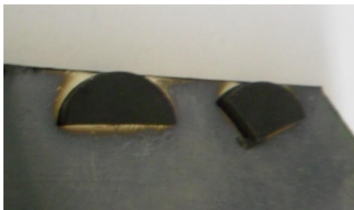
Figura 17. Amostras recobertas com camada ultrafina de ouro.
