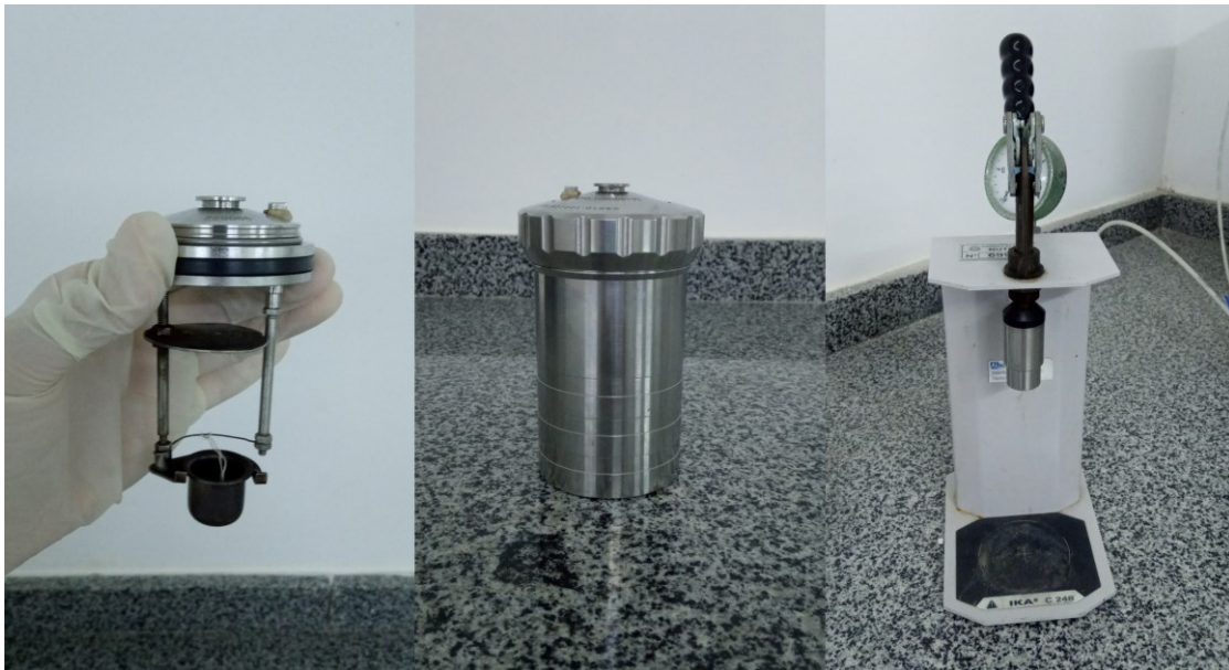
Figura 13 – Etapas de preparação da bomba para a pressurização com oxigênio ultrapuro na estação de gás
