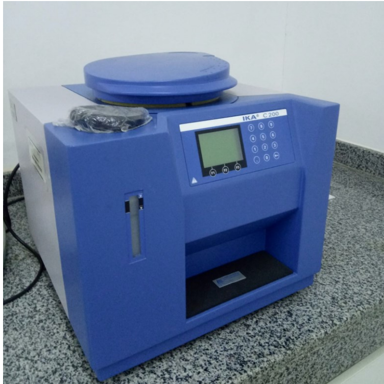
Figura 12 – Calorímetro de combustão IKA C200 utilizado para a determinação de PCS das amostras analisadas.
