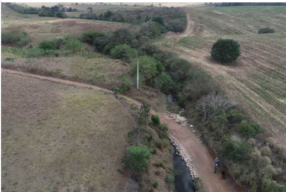
Figura 37 - Vista aérea da zona 6 (região central da imagem). Observa-se, apesar das condições de relevo desfavorável a presença de vegetação que age como atenuadora dos efeitos erosivos garantindo relativa estabilidade à unidade
