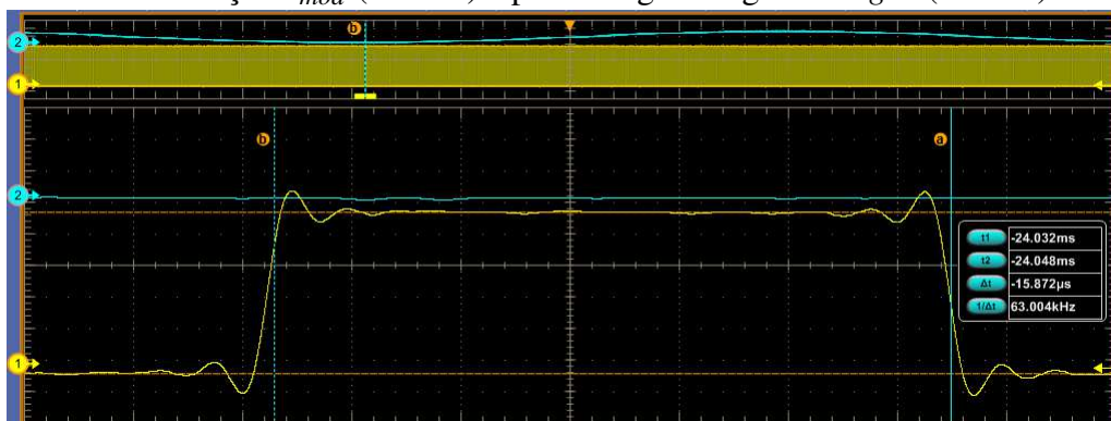
Figura 90 – Formas de onda para perturbação na frequência de 10 Hz: vale do sinal de modulação \hat{v}_{mod} (canal 2) e pulso de gatilho gerado V_{gs2} (canal 1)
