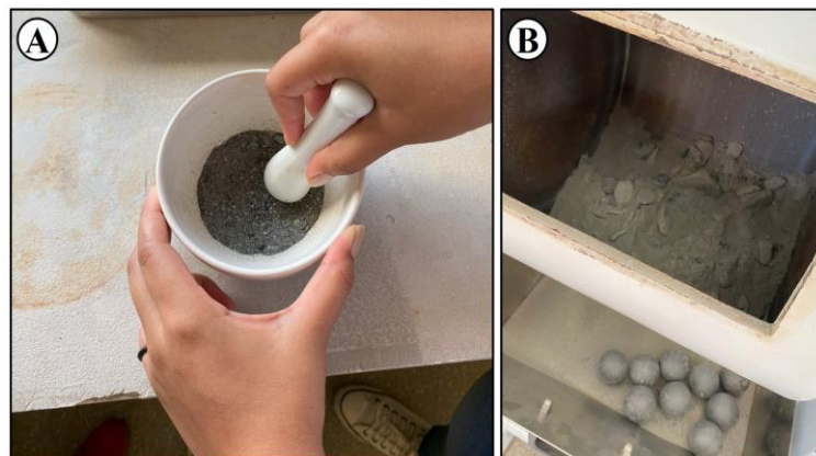
Figura 18 – Em (A) Tratamento no almofariz da argila e dos resíduos minerais e (B) Resíduo de esmeralda no moinho de bolas para o processo de cominuição.
