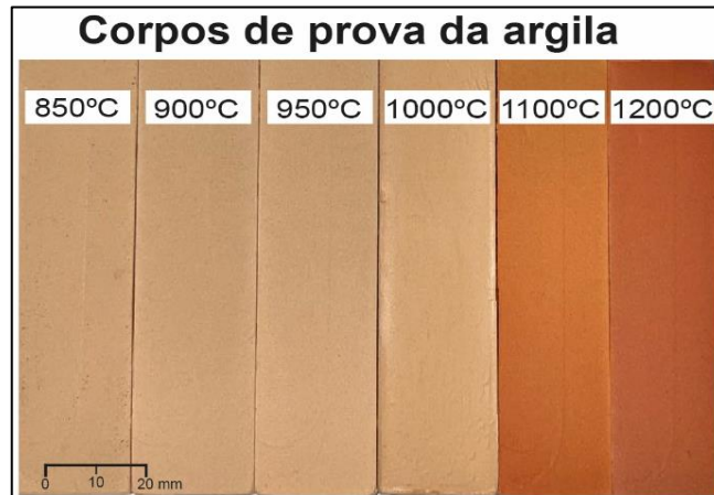
Figura 31 – Coloração dos corpos de prova da argila de Umbuzeiro após o processo de queima.
