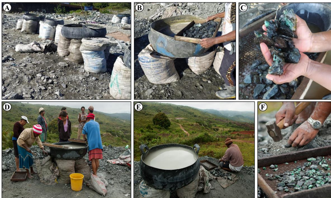
Figura 12 – Em (A) resíduo que sobra das escavações (ensacados), chamados localmente de “arroio”; em (B), (D) e (E) quijileiros realizando a lavagem do resíduo da esmeralda, e; (C) e (F) resíduo com teor baixo de minério.
