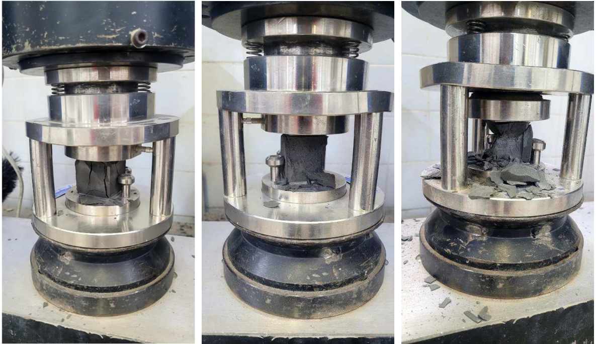
Figura 2 - Teste de Ruptura em Corpo de Prova na Prensa de Compressão Axial
