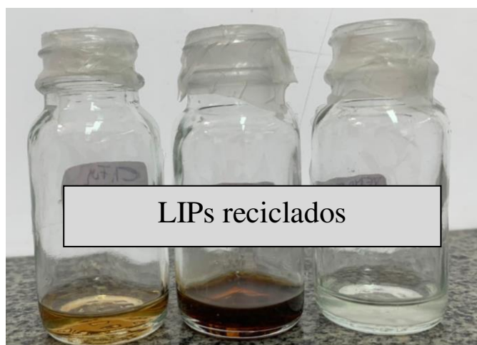
Figura 35 – Líquidos iônicos reciclados pós uso no processo de hidrólise de microplásticos a 130°C e 1,5h.
