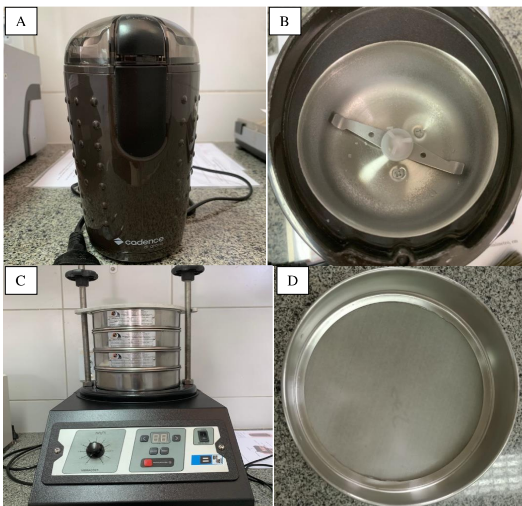
Figura 21 – Procedimento experimental de preparação dos MPs. A – Moedor utilizado no processo; B – Interior do moedor; C – Agitador eletromagnético; D – Peneira utilizada na seleção granulométrica ( 63\mu\text{m} a 500\mu\text{m} ).
