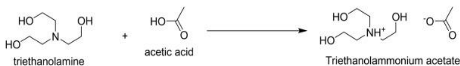
Figura 18 – Reação de síntese do acetato de trietanoamônio.
