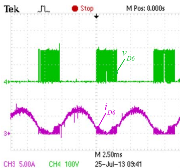
Figura 5.18 – Tensão v_{D6} (100 V/div) e corrente i_{D6} (5 A/div) no diodo D_6 ; (2,5 ms/div).
