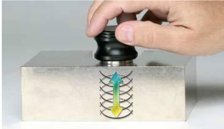
Figura 1: Transdutor normal utilizado na captura de sinal ultrassônico pela técnica pulso eco.
