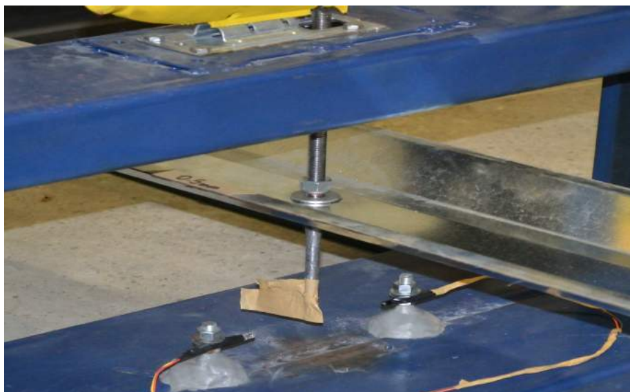
Figura 4.22 – Passagem da barra rosqueada pela telha.
