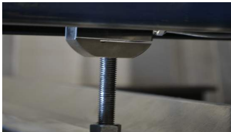
Figura 4.9 – Célula de carga sendo ligada na parte inferior à telha.
