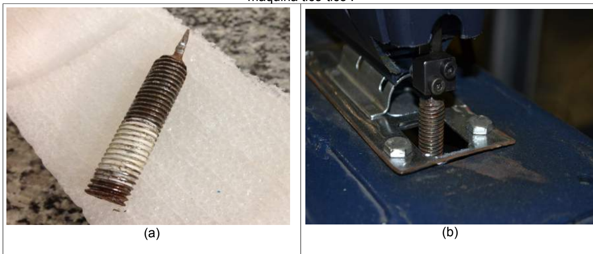
Figura 4.7 – (a) Barra para transmitir o carregamento oscilatório. (b) Detalhe da fixação com a máquina tico-tico .
