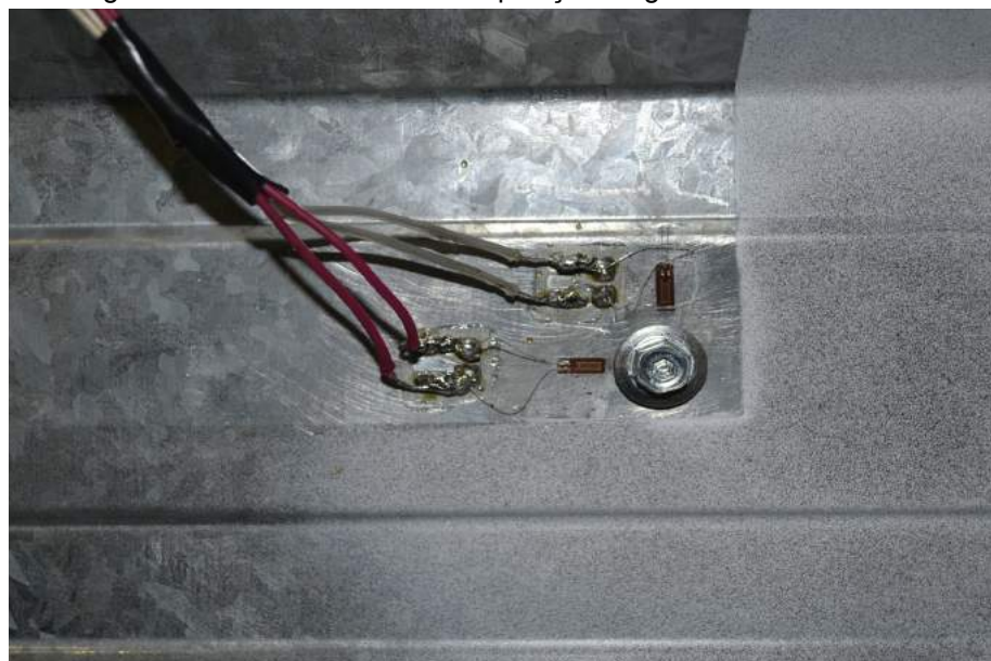
Figura 4.14 – Extensômetros na posição longitudinal e transversal.
