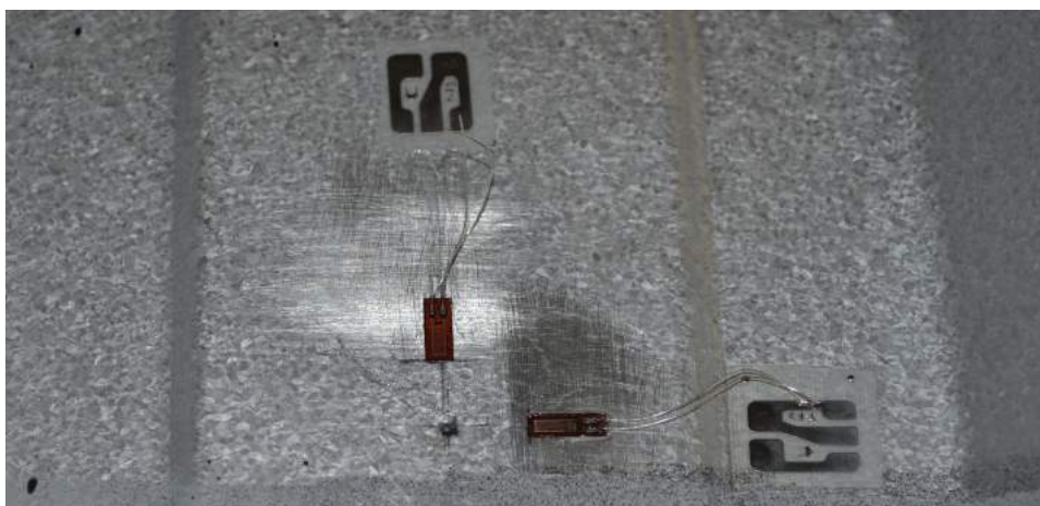
Figura 4.15 – Superfície da telha para receber os extensômetros.
