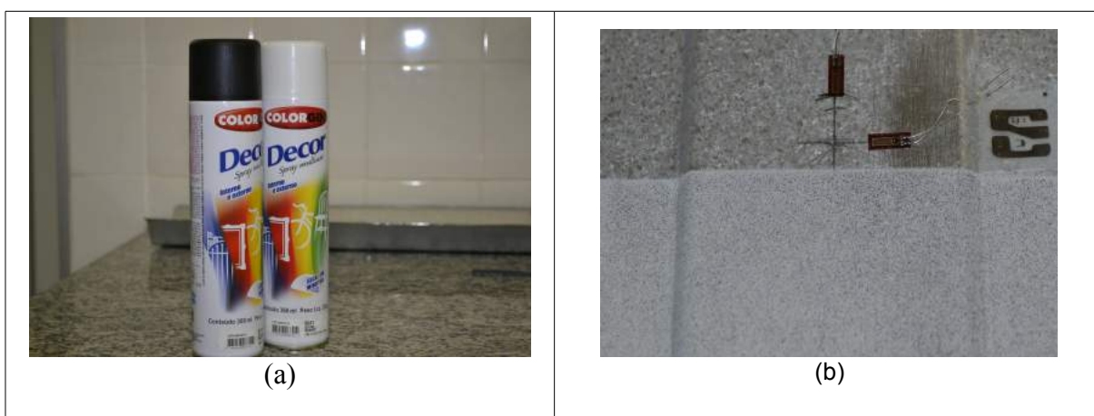
Figura 4.20 – (a) Spray para pintura da telha; (b) telha pintada com contraste.
