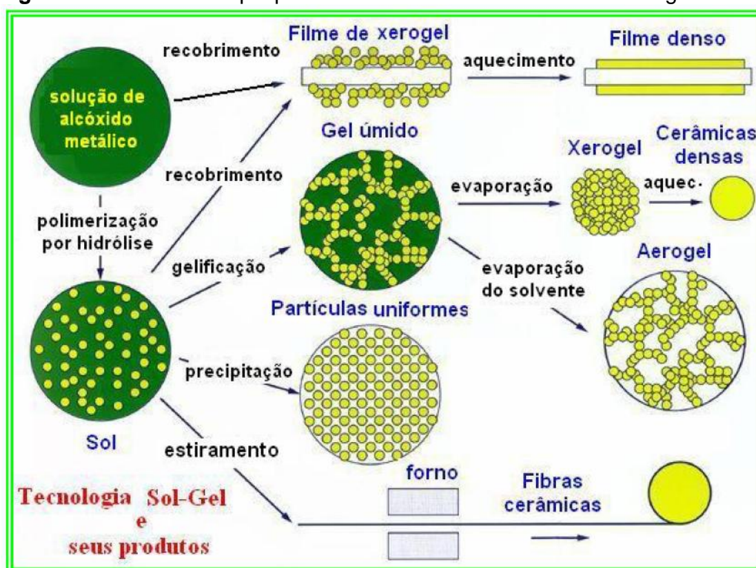
Figura 4.4 — Produtos que podem ser formados com o método sol-gel.
