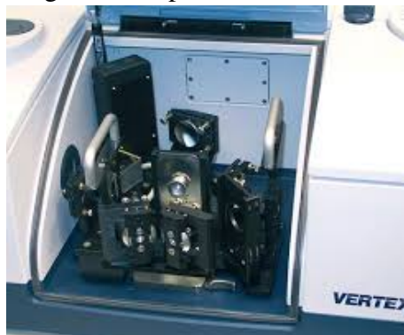
Figura 8 – Acessório de amostragem FTIR para o VERTEX 70v.
