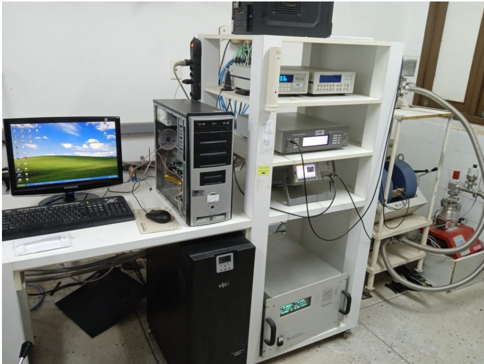
Figura 9 – Magnetômetro de Amostra Vibrante utilizado para determinar as curvas de histerese.
