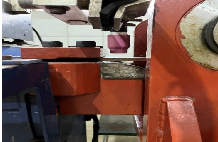
Figura 14 – Exemplificação de uma amostra posicionada para realização do ensaio Trans-Varestraint.
