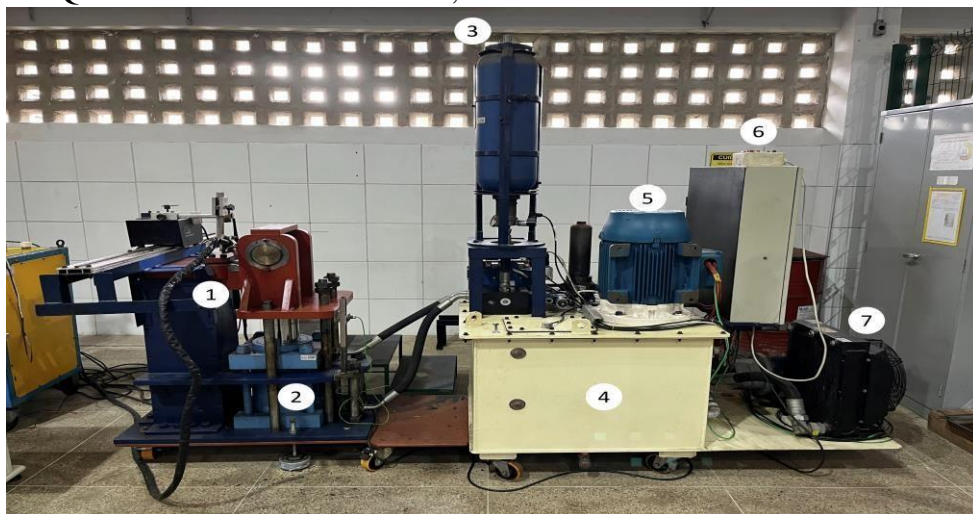
Figura 11 – Máquina de ensaio Trans-Varestraint: 1 – Sistema de fixação da peça e posicionamento da tocha; 2 – Cilindro hidráulico; 3 – Sistema acumulador de pressão; 4 – Unidade e tanque hidráulico; 5 – Motor-bomba; 6 – Quadro de comando e controle; 7 – Sistema de resfriamento do óleo.
