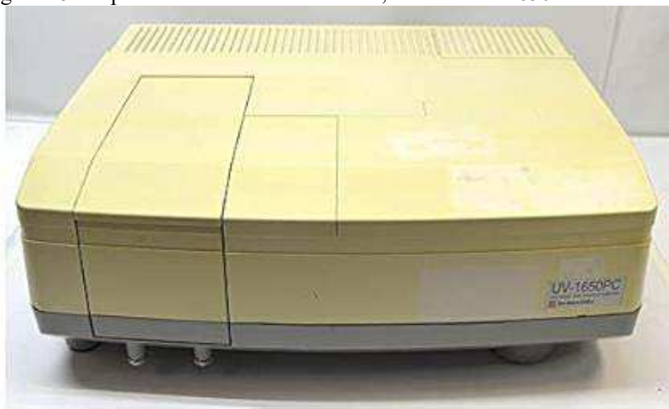
Figura 18 - Espectrofotômetro da Shimadzu, modelo UV-1650
