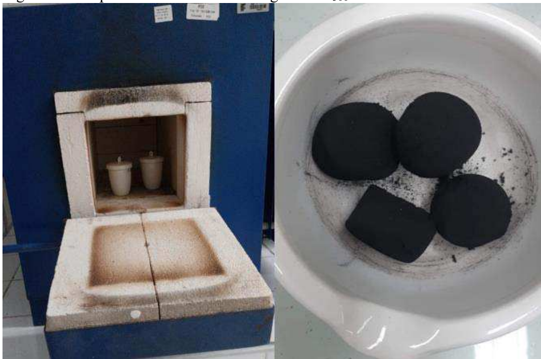
Figura 20 - Preparo do biocarvão de serragem BCS 500
