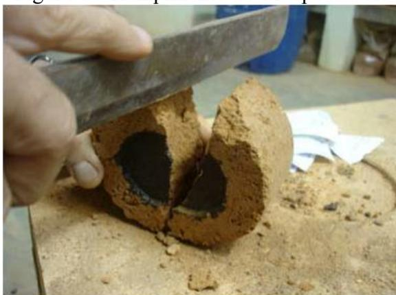
Figura 5 – Detalhe da medida das penetrações
