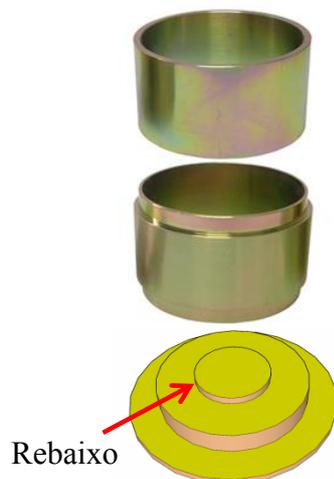
Figura 2 – Compactador Marshall manual
