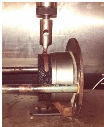
b) Aplicação da carga em interface sem tensões axiais
