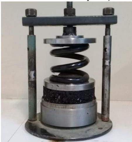
a) Detalhe da mola de aplicação da força axial
