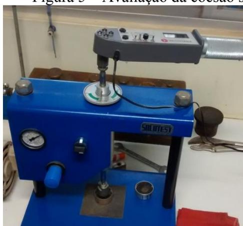
(a) Torquímetro acoplado ao coesímetro
