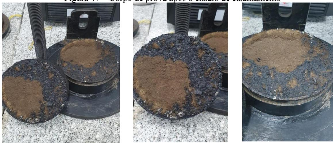
a) Corpo de prova rompido
