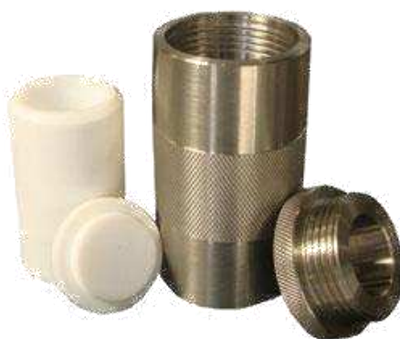
Figura 30. Sistema de autoclave usado para a síntese da zeólita.
