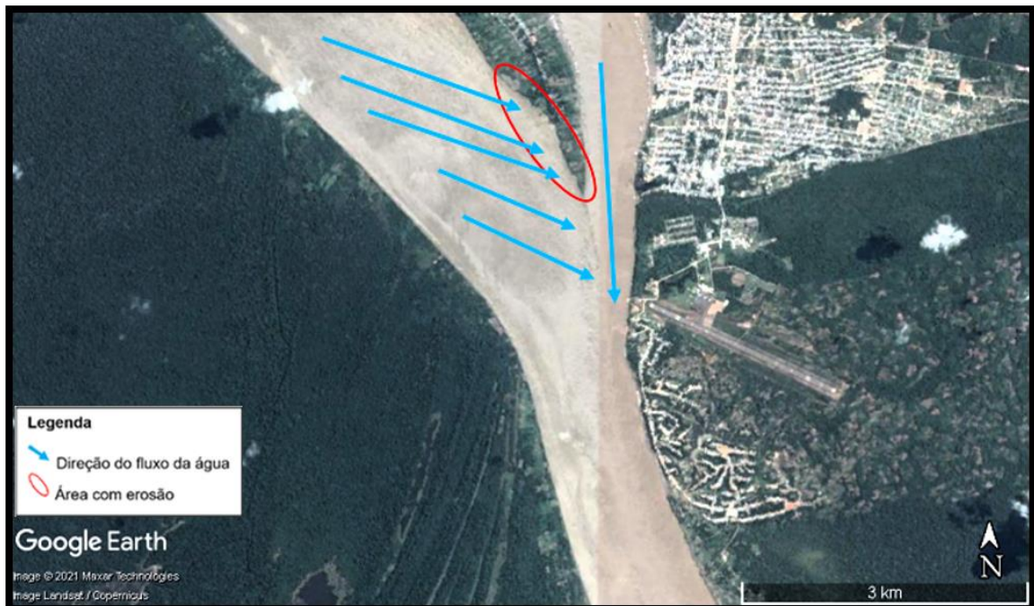
Figura 9 – Ausência das barras de sedimentos no canal
