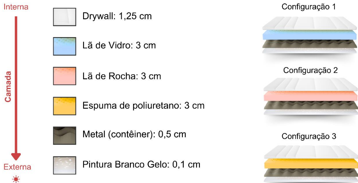
Figura 20 - Descrição das camadas de isolamento.
