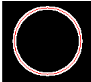
Figura 15 – Exemplo de uma banda estreita (em branco) em torno da curva de propagação (em vermelho).
