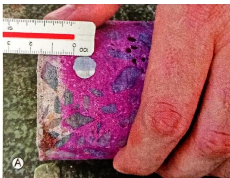
b) Carbonatação do concreto. Fonte: Bolina, Tutikian e Helene (2019).
