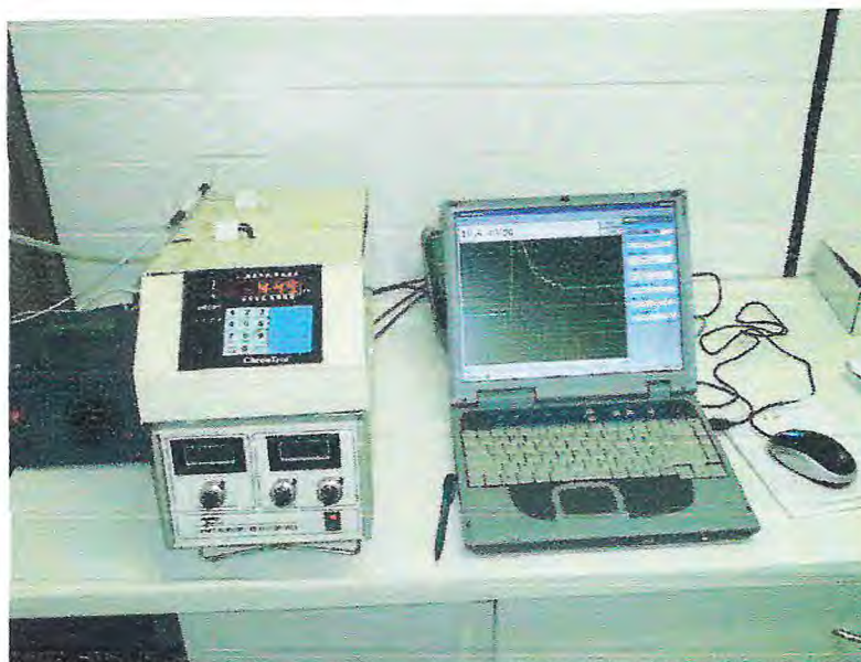
Figura 3.9. - Sistema analítico de dessorção e detecção com detector de fluorescência Tekran 2500.
