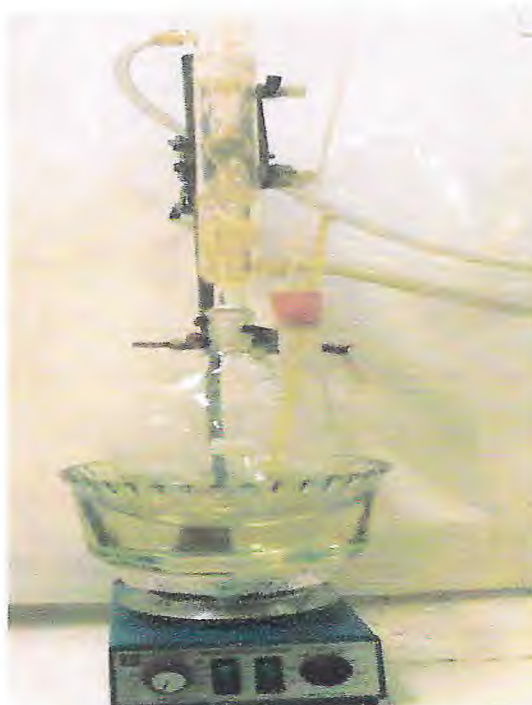
Figura 3.2. – Sistema de refluxo usado na produção do agente intercalante (oligômero) e na intercalação deste nas argilas homoionizadas.
