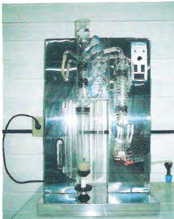
Figura 3.6. - Destilador de Kjeldahl usado na determinação da capacidade de troca catiônica total das argilas estudadas do Laboratório de Físico-química Mineral e Catalise do Departamento de Química da UFC.
