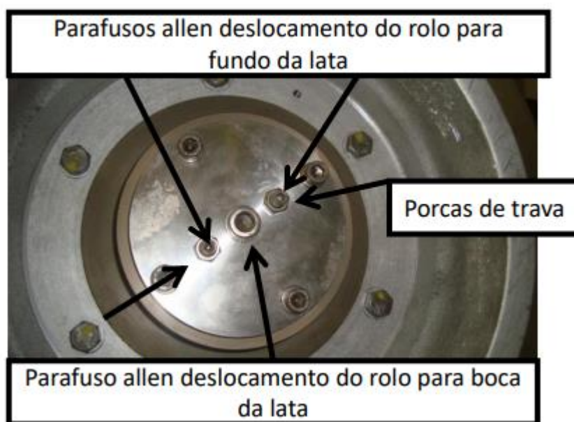
Figura 10 - os parafusos de rolo de aplicador e suas funções. Fonte: CANPACK (2023)
