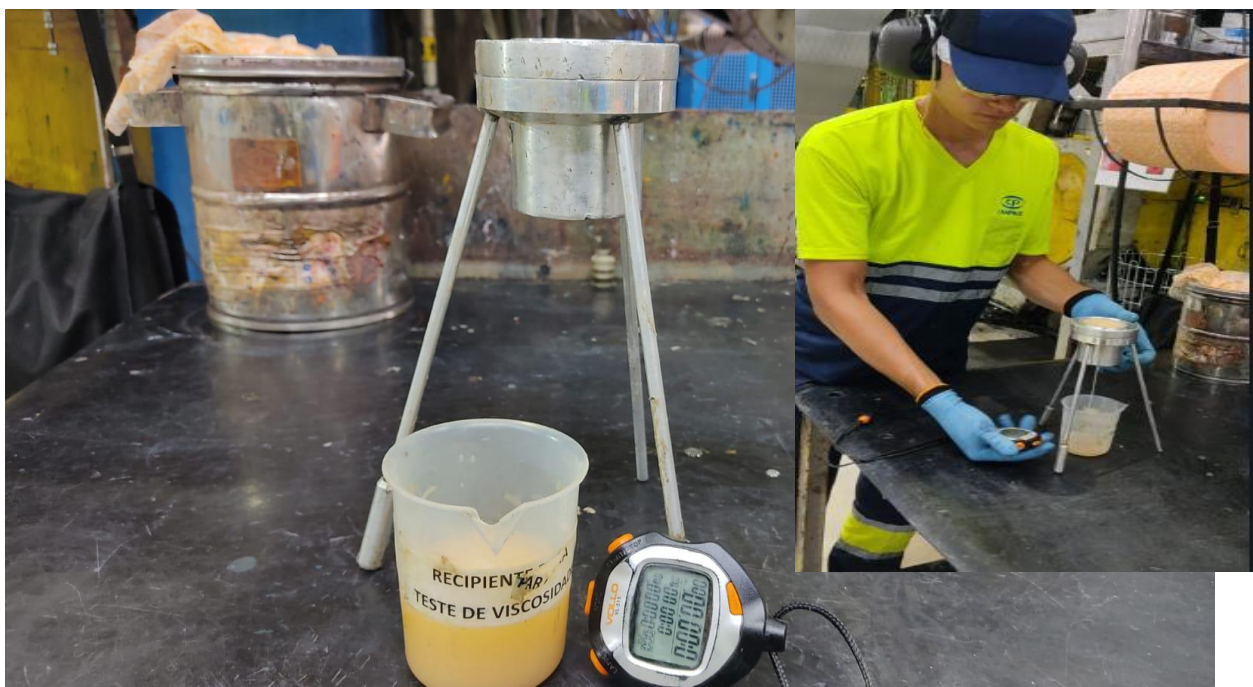
Figura 2 - Medição da viscosidade do verniz.
