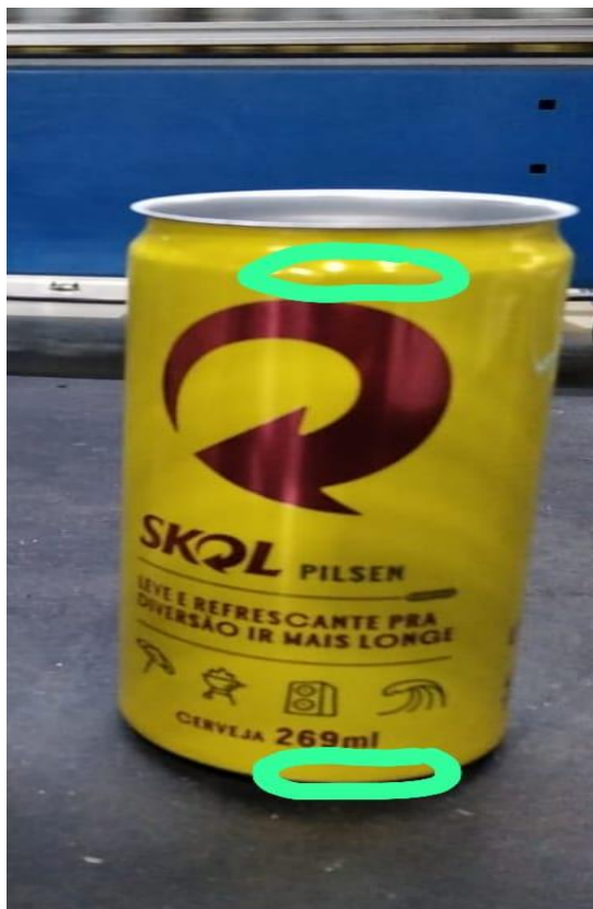
Figura 1 - Dois pontos que ocorrem a maior incidência de abrasão. Fonte : Autor (2023)
