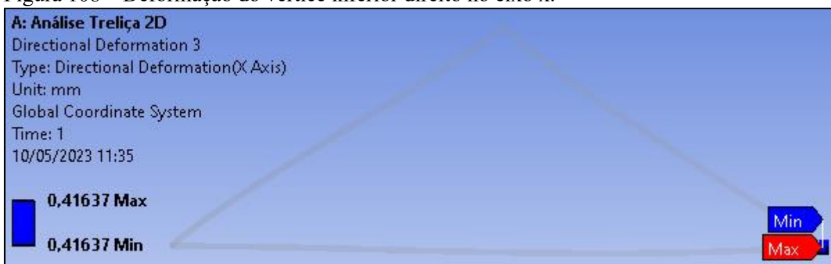
Figura 108 – Deformação do vértice inferior direito no eixo x.
