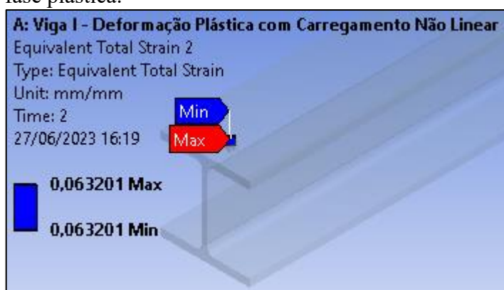
Figura 93 – Deformação total equivalente de um nó na fase plástica.
