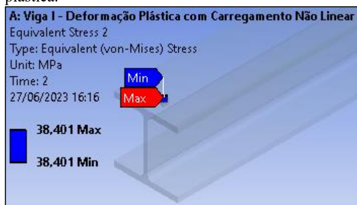
Figura 92 – Tensão equivalente de um nó na fase plástica.
