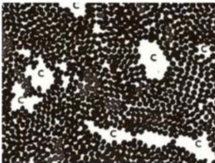
Figura 2.4 – Produtos da hidratação do cimento
