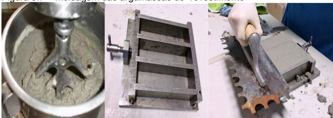
Figura 3.7 – Moldagem das argamassas de revestimento
