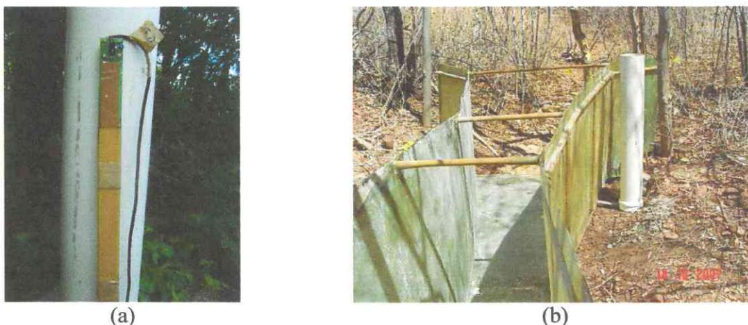
Figura 17 – Linígrafo de medição de nível do escoamento, (a) sensor capacitivo para monitoramento do nível de água e (b) poço tranquilizador onde é instalado o sensor de nível na calha Parshall.
