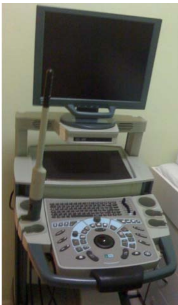
Figura 1- Equipamento BK medical Pro-focus ® 2050 formado por uma mesa de controle, um monitor de 19 polegadas e um transdutor endorretal tridimensional.
