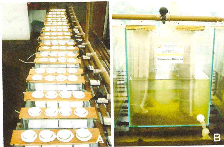
Figura 5.2- Aspecto dos aquários usados para montagem dos microcosmos nos ensaios de biorremediação utilizando sedimento de manguezal contaminado com borra oleosa.
