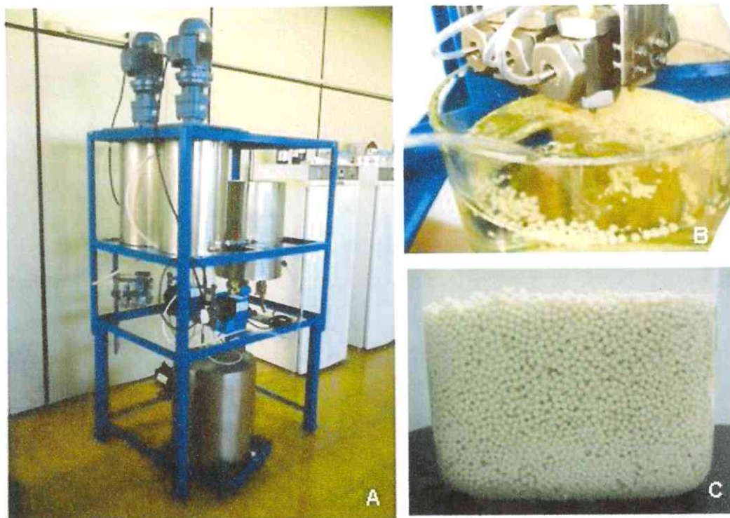
Figura 5.8- Máquina de produção em maior escala de esferas de quitosana (MEQ) (A), detalhe dos cabeçotes injetores (B) e aspecto morfológico das esferas produzidas (C).
