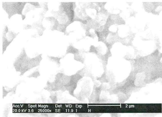
Figura 42. Micrografia das biocerâmicas de HAP com 30 % da blenda GalQ (GalQ30 )
