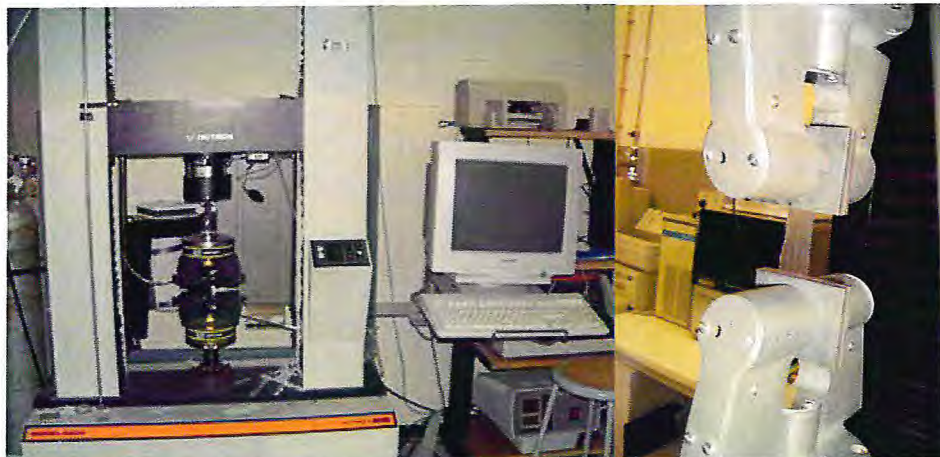
Figura 12 – Imagem da máquina de testes universais Instron, com ampliação do filme de galactomanana posicionado entre as garras durante o teste.
