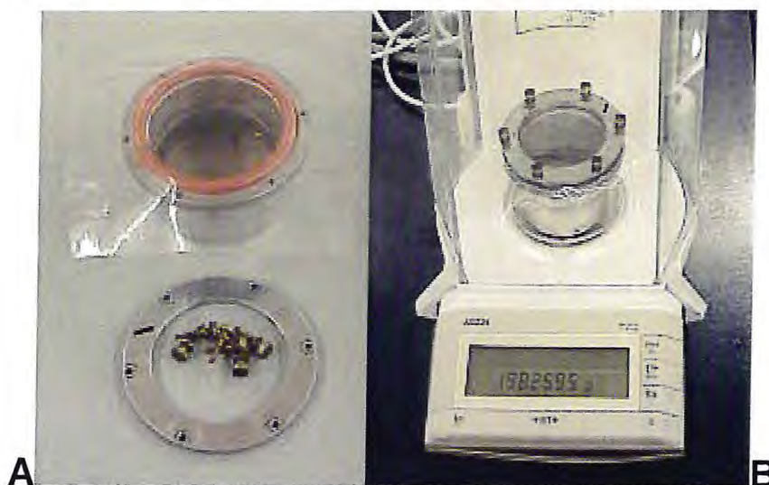
Figura 11 – Modelo adotado nos experimentos de Permeabilidade ao Vapor de Água. A – Célula de Permeação ; B – Pesagem da Célula de Permeação com o filme de galactomanana.
