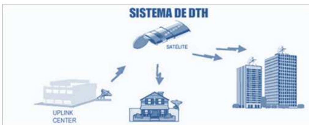
Figura 2 – Tecnologia do sistema de Direct to Home (DTH)
