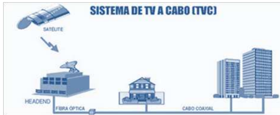
Figura 1 – Tecnologia do sistema de TV a Cabo (TVC)
