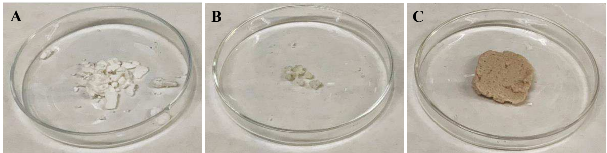
Figura 10 – Borrachas naturais obtidas a partir da coagulação ácida com ácido acético dos látices de Calotropis procera (A), Plumeria pudica (B) e Himatanthus drasticus (C).
