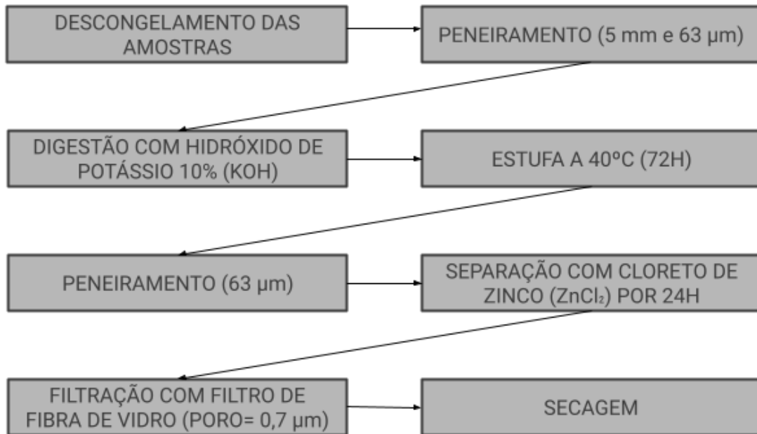
Figura 3 – Fluxograma da metodologia de extração de microplásticos empregada neste estudo.
