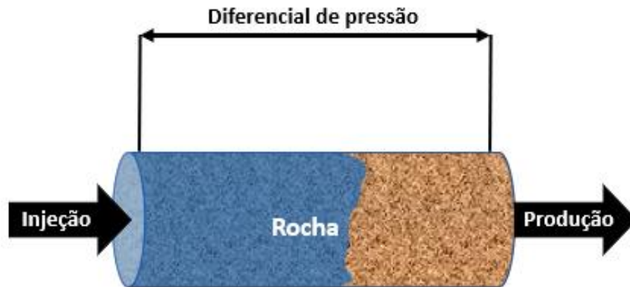
Figura 3 – Esquema do aparato experimental para teste de injeção de água em rocha em regime transiente
