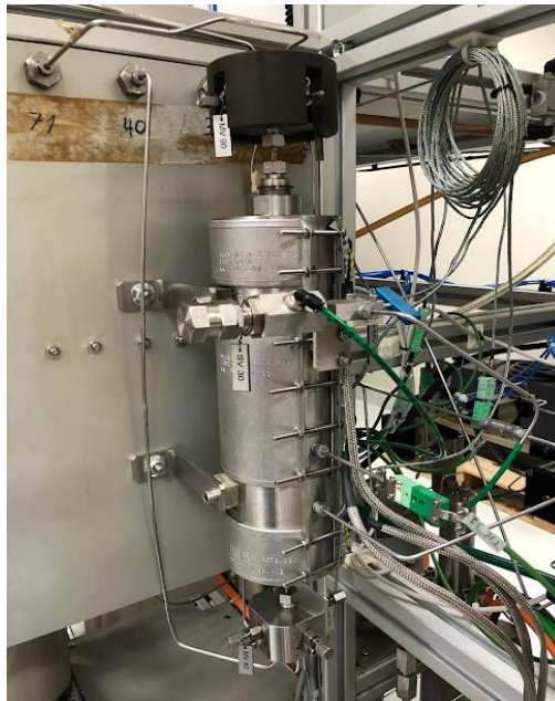
Figura 18 – Célula de confinamento da amostra de rocha
