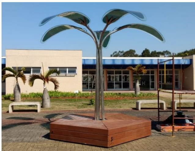
Figura 19 - Árvore solar com folhas de células solares orgânicas
