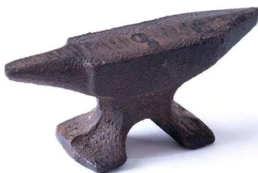
Fig. 68. Bigorna (ferramenta utilizada para forjar objetos de metal)
