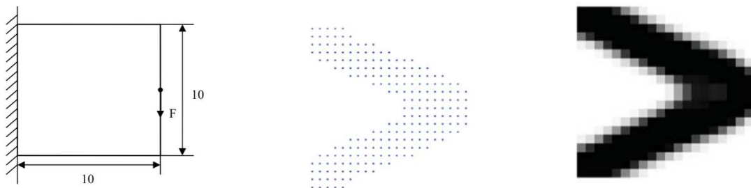
Figura 4 – Projeto ótimo obtido para uma viga em balanço com o modelo proposto por Zheng et al. (2008). O resultado foi comparado com o alcançado utilizando o MEF.
