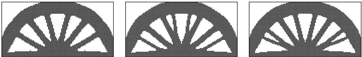
Figura 37 – Resultados para o problema da viga simplesmente apoiada com diferentes discretizações.
