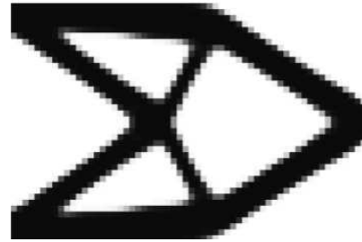
Figura 23 – Comparação do resultado obtido para o problema da viga em balanço com outros encontrados na literatura.
