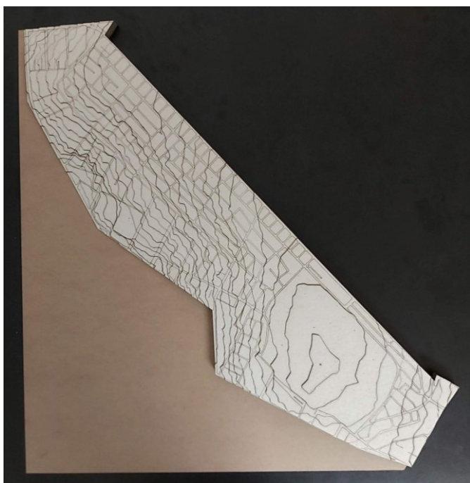
Figura 38. Maquete de curvas de nível executada em fresadora. Fonte: Acervo de imagens do PIRF (2019).
