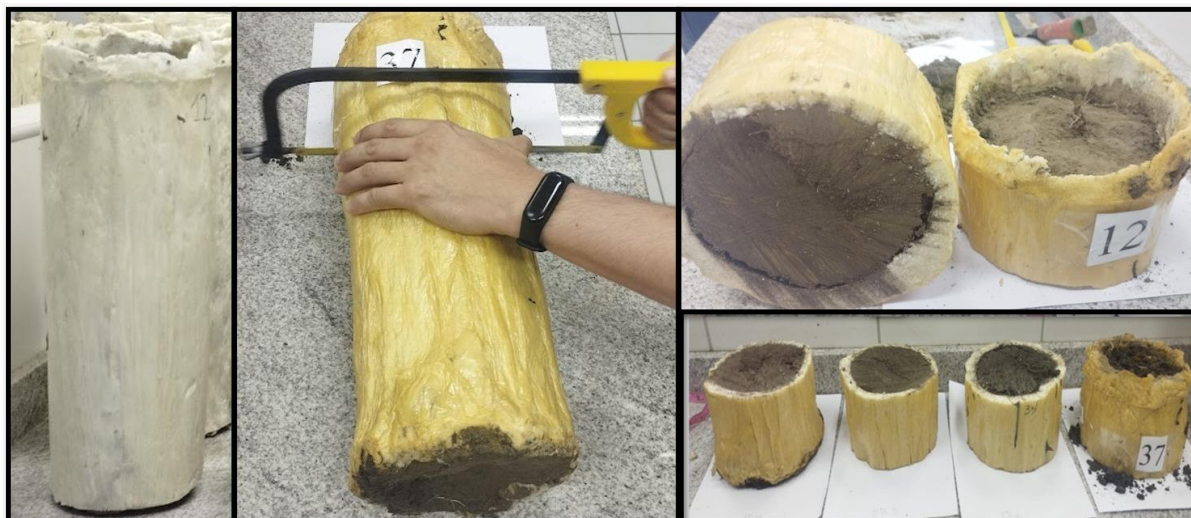
Figura 03 – Divisão da coluna de solo em quatro camadas
