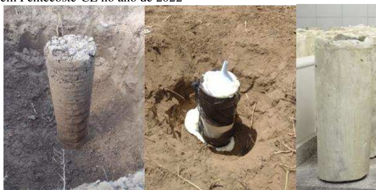
Figura 02 – Processo de coleta das colunas de solo com estrutura preservada coletado em Pentecoste-CE no ano de 2022
