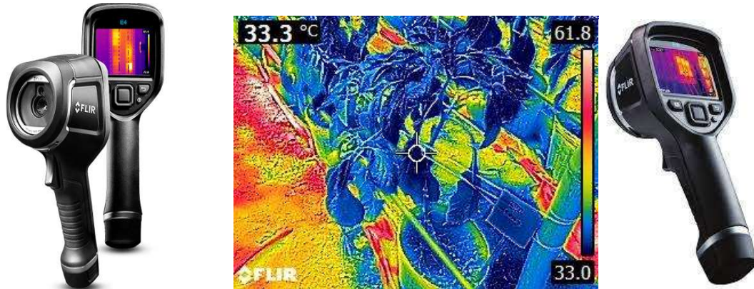
Figura 7 – Câmera termográfica FLIR e imagem capturada pela câmera.
