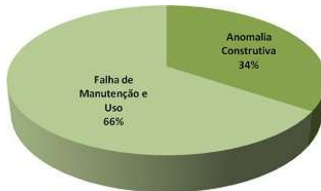
Figura 2 – Distribuição da incidência dos acidentes prediais por tipo de origem
