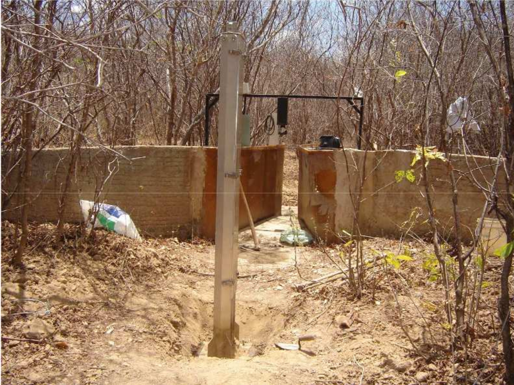
Figura 6 – Calha Parshall e amostrador de sedimentos no Riacho Boqueirão, Bacia Experimental de Aiuaba
