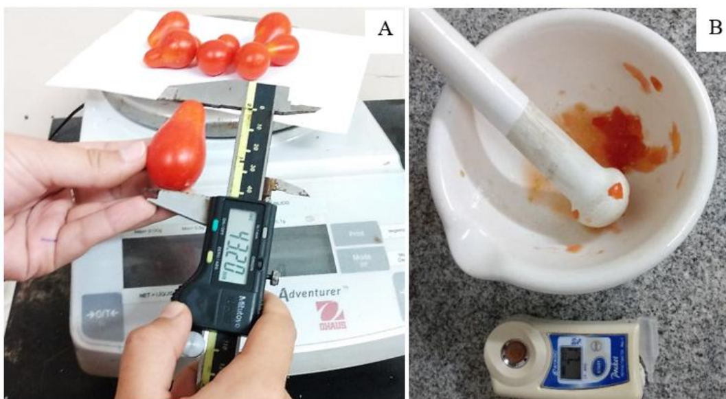
Figura 21. Análise da qualidade dos frutos de tomate cereja. A - Mensuração e pesagem dos frutos de tomate cereja. B - Maceração dos tomates e análise do °Brix.
