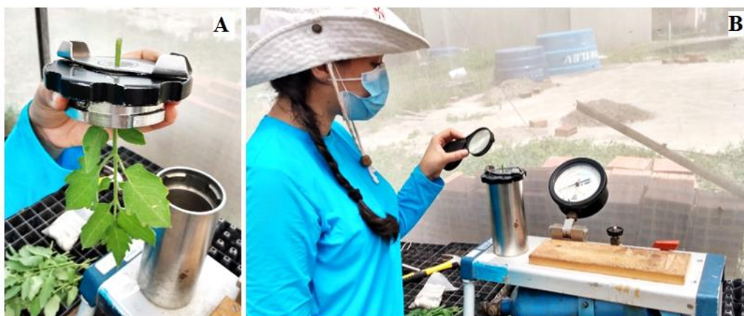
Figura 24. Bomba de Scholander para coleta do potencial hídrico das folhas: Inserção do pecíolo (A) e verificação da exsudação (B).
