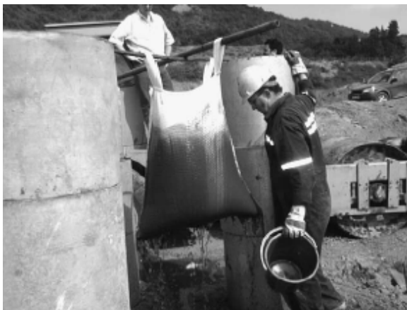
Figura 16 – Ensaio de bolsa suspensa ou saco pendurado
