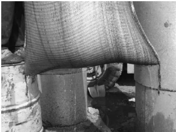
Figura 17 – Gotejamento do filtrado em ensaio de bolsa suspensa
